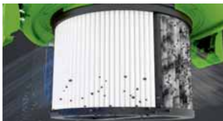
Automatische filterreiniging elke 45 seconden
